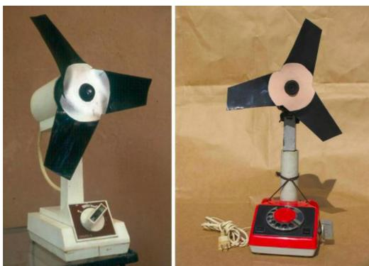
Figura 3 – Ventilador com motor de máquina de lavar russa da marca Aurika 70.
